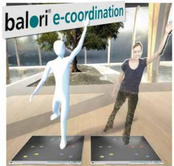
Die Druckmessplatten beinhalten hochwertige kapazitive Sensoren von zebriS zur exakten Ermittlung der Balance und Bewegungsqualität. Sie folgen einfach dem Avatar und können dadurch völlig selbstständig trainieren.
